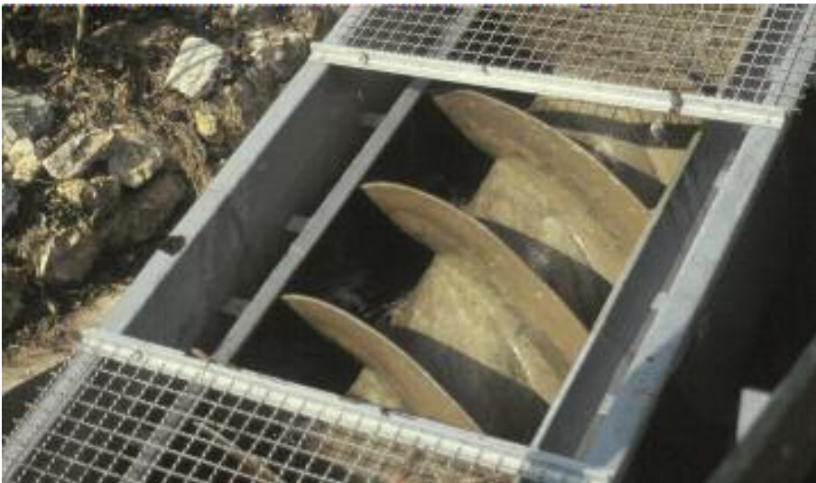
Bild 3.24: Wasserkraftschnecke, Ansicht (oben) und Detail (Schnecke) (unten)
